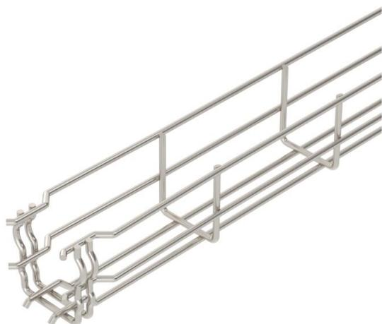
Passerella grigliata ad innesto rapido, con bordo di altezza pari a 55 mm. Per la passerella grigliata non sono necessari ulteriori componenti di collegamento in quanto vengono semplicemente inserite l'una nell'altra. La larghezza della maglia è di 50 x 100 mm (eccezione GRM 55/50 = 20 x 100 mm). Schermatura magnetica senza coperchio 15 dB, con coperchio 25 dB.
