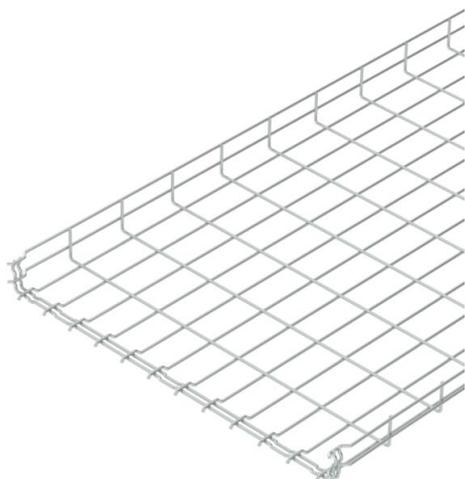
Passerella grigliata ad innesto rapido, con bordo di altezza pari a 55 mm. Per la passerella grigliata non sono necessari ulteriori componenti di collegamento, le due estremità vengono semplicemente inserite una nell'altra. La larghezza della maglia è di 50 x 100 mm (eccezione GRM 55/50 = 20 x 100 mm).
