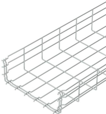
Passerella grigliata ad innesto rapido, con bordo di altezza pari a 105 mm. Per la passerella grigliata non sono necessari ulteriori componenti di collegamento in quanto vengono semplicemente inserite l'una nell'altra. La larghezza di maglia è pari a 50 x 100 mm. Schermatura magnetica senza coperchio 15 dB, con coperchio 25 dB.
