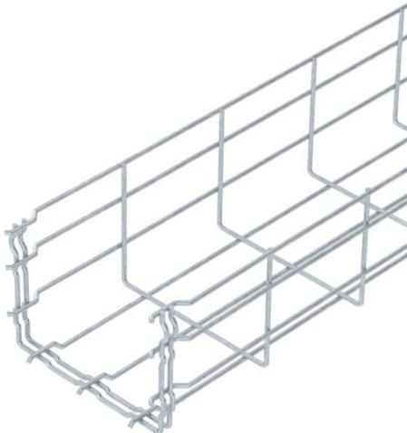
Passerella grigliata ad innesto rapido, con bordo di altezza pari a 105 mm. Per la passerella grigliata non sono necessari ulteriori componenti di collegamento, vengono semplicemente inserite l'una nell'altra. La dimensione delle maglie è pari a 50 x 100 mm. Schermatura magnetica senza coperchio 15 dB, con coperchio 25 dB.
