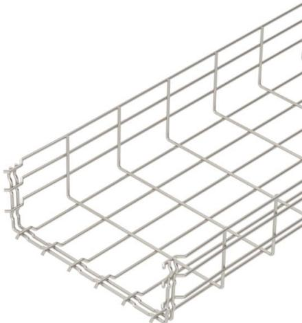
Passerella grigliata ad innesto rapido, con bordo di altezza pari a 105 mm. Per la passerella grigliata non sono necessari ulteriori componenti di collegamento, le due estremità vengono semplicemente inserite l'una nell'altra. La larghezza di maglia è pari a 50 x 100 mm. Schermatura magnetica senza coperchio 15 dB, con coperchio 25 dB.
