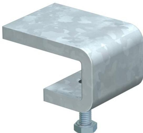
Morsetto per il fissaggio della griglia angolare tipo GW 40/80 su travi in acciaio. Per la scelta del dispositivo di fissaggio fare attenzione allo spessore della flangia del supporto in acciaio.
