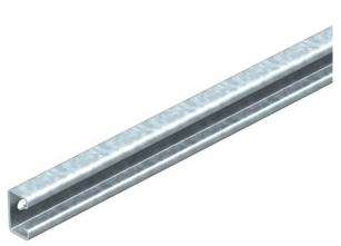
Profilati MS4022 per l'utilizzo come piolo in passerelle a scaletta pesanti. Carico massimo per i pioli 175 kg. La staffa reggicavo idonea è il tipo 2056U.
