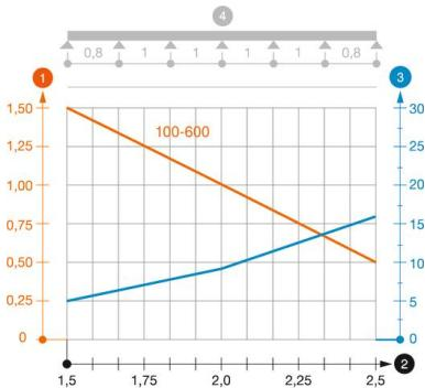
Diagramma di carico passerella portacavi tipo MKS 60
