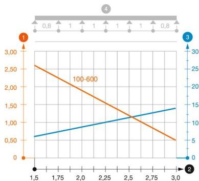
Diagramma di carico passerella portacavi tipo SKS 60
