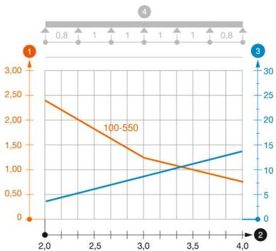
Diagramma di carico passerella portacavi tipo SKS 110
