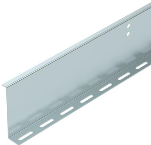
Separatore per il sistema di passerelle portacavi calpestabile BKRS. Fissaggio con viti a testa tonda M 6 x 12 mm nella foratura pavimento. A partire da una larghezza di 200 mm si dovrebbe utilizzare un separatore con dimensione massima dello scomparto di 220 mm.
