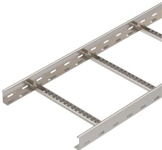
Passerella a traversini con longerone forato, con bordo di altezza pari a 60 mm, pioli del profilato a C rivettati e aperti verso l'alto (versione VS). La passerella a traversini viene fornita in versione ripiegata.
