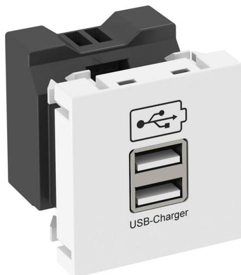
Presa USB con due porte USB Tipo A, per il caricamento di dispositivi mobili, corrente massima di carica 1x 2100mA o 2x 1050 mA.
