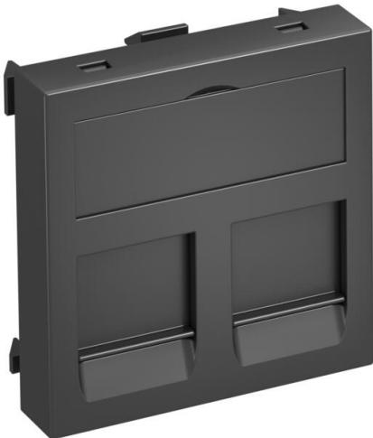
Supporto per sistemi di conessione alla linea dati. Il fissaggio a incastro è adatto per l'incasso orizzontale e verticale dei dispositivi. Il Tipo C ha una apertura di montaggio 19,30 x 14,80 mm ed è progettato per il fissaggio diretto dei moduli di connessione dati nell'apertura di montaggio.
