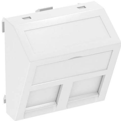
Supporto per moduli di connessione dati con uscita inclinata e chiusura per la presa di due moduli di collegamento per tecnica per dati con presa RJ45. Il fissaggio a incastro è adatto per l'incasso orizzontale e verticale dei dispositivi. Il Tipo C ha una apertura di montaggio 19,30 x 14,80 mm ed è progettato per il fissaggio diretto dei moduli di connessione dati nell'apertura di montaggio.
