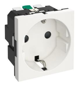
Presa Schuko protetta Italia, con protezione dal contatto diretto elevata, con morsetti a innesto, a 2 poli, 16 A, 250 V~, morsetti di collegamento secondo IEC 60884-1
