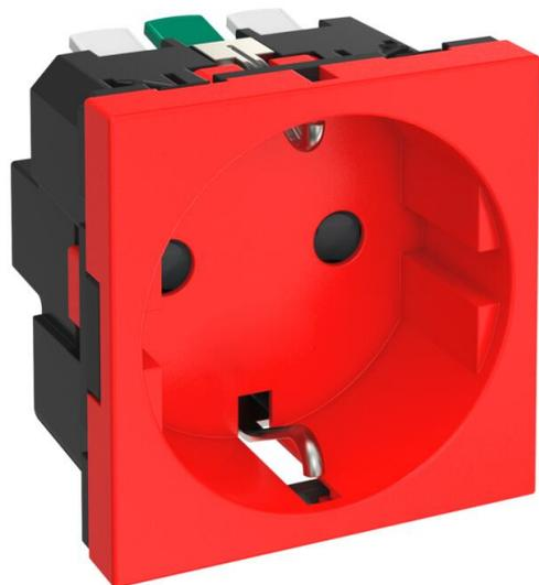
Presca Schuko protetta Italia, con protezione dal contatto diretto elevata, con morsetti a innesto, a 2 poli, 16 A, 250 V~, morsetti di collegamento secondo IEC 60884-1.
