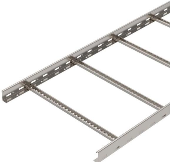
Passerella a traversini con bordo di altezza pari a 60 mm, con pioli del profilato C30 aperti verso l'alto saldati. Longherone laterale arrotondato come rinforzo e protezione dei bordi. Il fissaggio alla mensola viene eseguito con morsetti tipo LKS 40. La misura dell'asola del piolo è pari a 16,5 mm, la staffa reggicavo è il tipo 2056.
