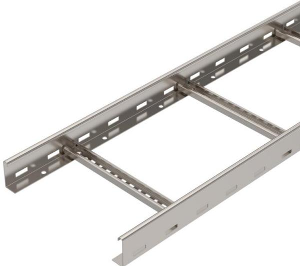
Passerella a traversini con bordo di altezza pari a 60 mm, con pioli del profilato C30 aperti verso l'alto saldati. Longherone laterale arrotondato come rinforzo e protezione dei bordi. Il fissaggio alla mensola viene eseguito con morsetti tipo LKS 40. La misura della scanalatura del piolo è pari a 16,5 mm, la staffa reggicavo è il tipo 2056. Schermatura elettromagnetica senza coperchio 10 dB, con coperchio 15 dB.
