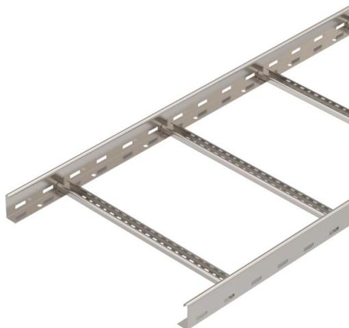
Passerella a traversini con longherone forato, con bordo di altezza pari a 60 mm, pioli del profilato a C rivettati e aperti verso l'alto (versione VS). La passerella a traversini viene fornita in versione ripiegata.
