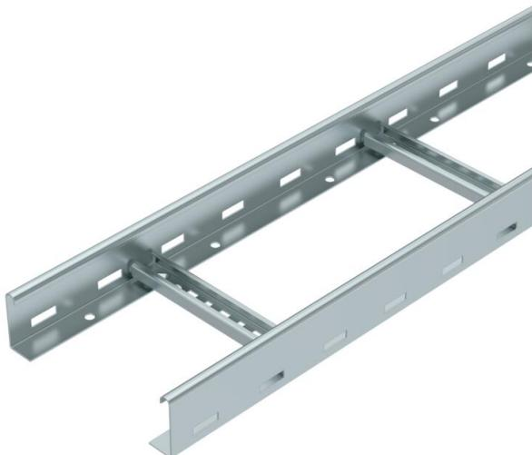
Passerella a traversini con bordo di altezza pari a 60 mm, con pioli del profilato C30 aperti verso l'alto saldati. Longherone laterale arrotondato come rinforzo e protezione dei bordi. Il fissaggio alla mensola viene eseguito con morsetti tipo LKS 40. La misura della scanalatura del piolo è pari a 16,5 mm, la staffa reggicavo è il tipo 2056.
