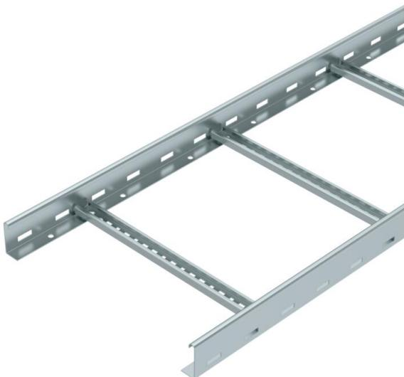
Passerella a traversini con bordo di altezza pari a 60 mm, con pioli del profilato C30 aperti verso l'alto saldati. Longherone laterale arrotondato come rinforzo e protezione dei bordi. Il fissaggio alla mensola viene eseguito con morsetti tipo LKS 40. La misura della scanalatura del piolo è pari a 16,5 mm, la staffa reggicavo è il tipo 2056.
