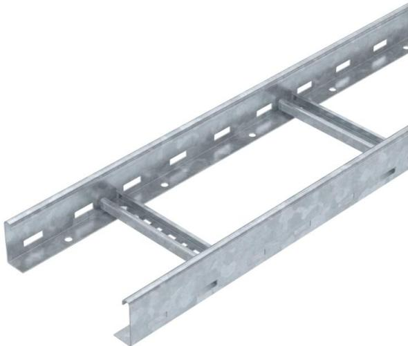
Passerella a traversini con bordo di altezza pari a 60 mm, con pioli del profilato C30 aperti verso l'alto saldati. Longherone laterale arrotondato come rinforzo e protezione dei bordi. Il fissaggio alla mensola viene eseguito con morsetti tipo LKS 40. La misura della scanalatura del piolo è pari a 16,5 mm, la staffa reggicavo è il tipo BS-H....
