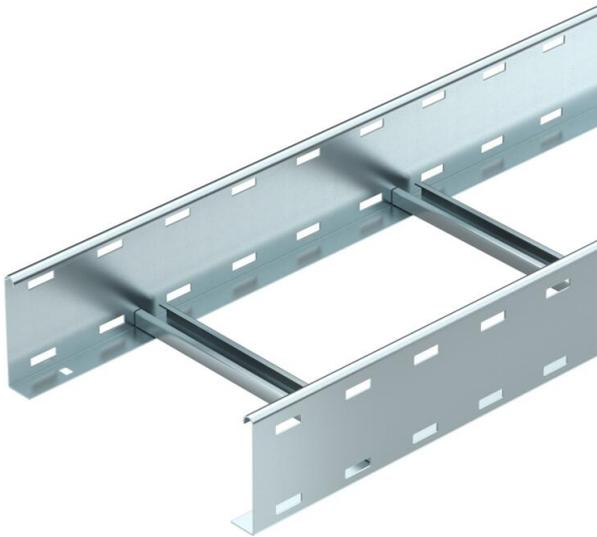
Passerella a traversini con longherone forato, con bordo di altezza pari a 110 mm, pioli del profilato a C rivettati e aperti verso l'alto.
