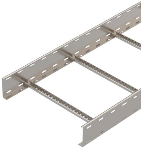
Passerella a traversini con longherone forato, con bordo di altezza pari a 110 mm, pioli del profilato a C rivettati e aperti verso l'alto.
