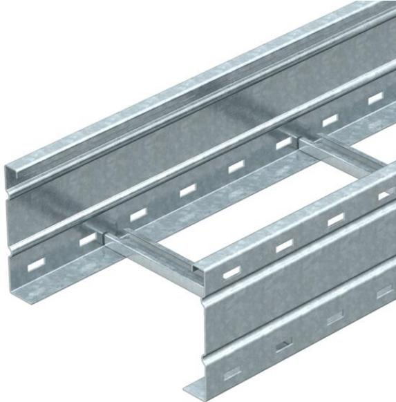
Passerella a traversini, grande portata, con longherone laterale asolato e bordo di altezza 160 mm. Fissaggio di cavi e linee con staffa reggicavo tipo 2056. I giunti lineari tipo WRV 160 devono essere ordinati separatamente. Schermatura elettromagnetica senza coperchio 10 dB, con coperchio 15 dB.
