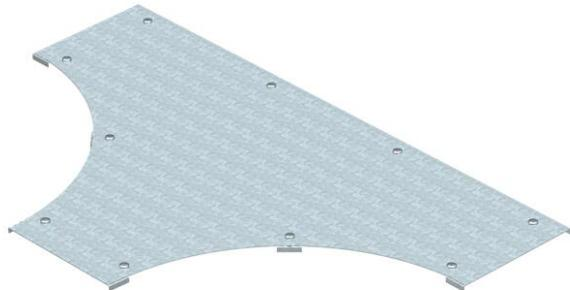
Coperchio per derivazione a T, pesante, con bussole girevoli premontate. Poiché il connettore è montato dall'esterno, il coperchio del raccordo è più corto di 300 mm rispetto al raccordo corrispondente. Questo deve essere considerato quando si installano gli elementi della linea.
