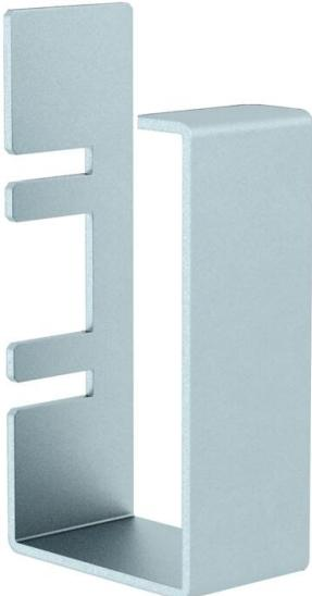
Morsetto di fissaggio per canale in metallo tipo LKM 60100FS, per l'ancoraggio del canale e delle relative linee durante l'installazione. Il morsetto di fissaggio è assolutamente necessario qualora il canale venga montato in impianti di cablaggio con mantenimento funzionale integrato secondo DIN 4102 parte 12. Semplifico montaggio tramite inserimento nel foro passante e bloccaggio della parete laterale.
