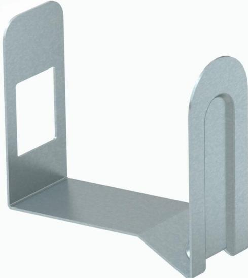
Il morsetto di fissaggio ferma il cavo inserito nel canale, facilitando così l'installazione a parete e a soffitto. Questi morsetti vengono fissati tramite foro passante ed agganciati alla parete laterale. Adatto per canale di larghezza 80 mm.
