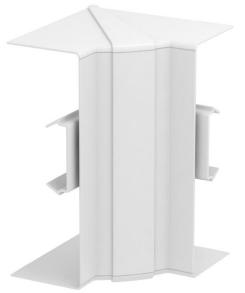
Coperchio per angolo interno in PC/ABS halogen free per la deviazione di direzione di canali per incasso apparecchi Rapid 80 dei sistemi GK, GKH, GS e GA. Regolabile in modo continuo da 85° a 95° e utilizzabili per canali simmetrici e asimmetrici.
