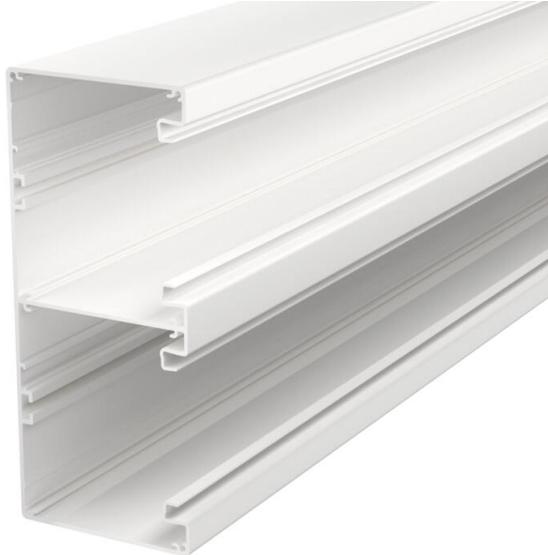
Canale porta apparecchi senza foratura alla base indicato per il montaggio diretto a parete o su mensole. Su richiesta possono essere realizzati anche elementi inferiori e superiori del canali e coperchi con lunghezze extra, fino a 6000 mm, e anche altri colori RAL. Le superfici esterne dei canali porta apparecchi sono laminate.
