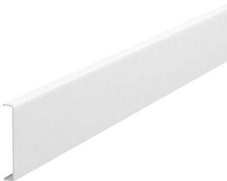
Coperchio per la chiusura dei canali porta apparecchi Rapid 80 GK (PVC), GS (acciaio), GA (alluminio) e colonne ISS con apertura sistema da 76,5 mm. Il contatto elettrico tra la parte superiore e quella inferiore del canale/della colonna è garantito dalle staffe di bloccaggio del tipo RKV3V. Per ogni lunghezza di fornitura (2000 mm) sono montati di serie 6 staffe di bloccaggio.
