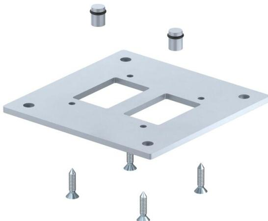
Flangia da pavimento per il fissaggio della colonna industriale ISS a pavimento. Nella fornitura sono comprese 4 viti di fissaggio per il montaggio della flangia pavimento sul profilo della colonna e 2 tappi a tenuta per la chiusura dei canali dell'aria compressa.
