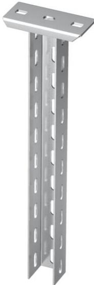
Profilato di sospensione (profilato a U) con piastra di testa saldata. Per il fissaggio a soffitti in calcestruzzo orizzontali e supporti in acciaio. Nel caso si utilizzino mensole di lunghezza 400 millimetri o oltre oppure si montino le mensole alla fine del supporto di sospensione si consiglia di utilizzare il distanziatore, tipo DSK 45
