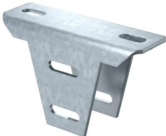
Supporto a soffitto variabile per il montaggio su profilati US 5. In combinazione con il profilato US 5 è possibile realizzare in loco profilati di sospensione di qualsiasi lunghezza. Con il supporto a soffitto regolabile è possibile bilanciare le sospensioni con inclinazione fino a 30°.
