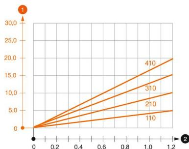
Diagramma di carico mensola tipo MWA 12
