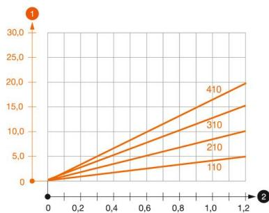
Diagramma di carico mensola tipo MWA 12
