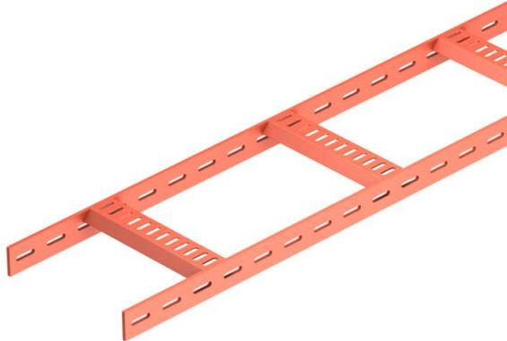
Passerella per impianti navali con longherone laterale asolato con bordo di altezza pari a 40 mm con pioli trapezoidali saldati, forati, aperti verso il basso. Carico testato secondo IEC in combinazione con connettore tipo SLV. Fondo di saldatura tipo SIGMA-WELD 199.
