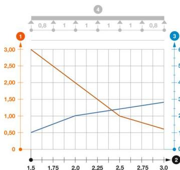
Diagramma di carico passerella tipo SL62
