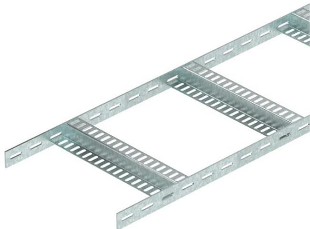
Passerella leggera per impianti navali con longherone laterale asolato con bordo di altezza pari a 35 mm con pioli saldati, forati, a Z. Carico testato secondo IEC in combinazione con connettore tipo SLV.
