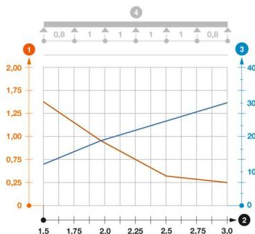
Diagramma di carico passerella tipo SLZ L
