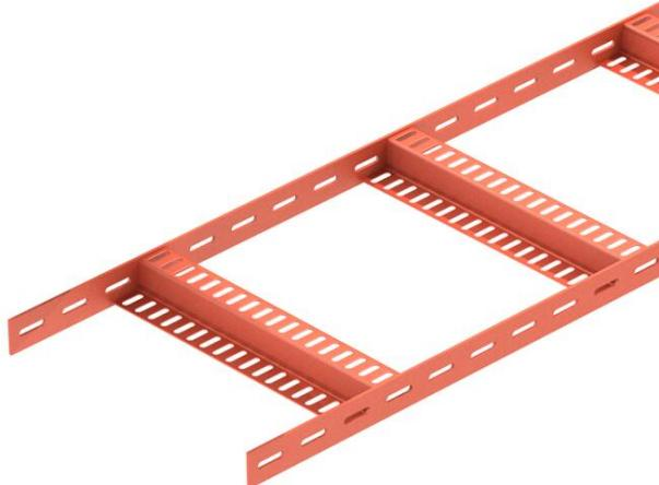
Passerella leggera per impianti navali con longherone laterale asolato con bordo di altezza pari a 35 mm con pioli saldati, forati, a Z. Carico testato secondo IEC in combinazione con connettore tipo SLV. Fondo di saldatura tipo SIGMA-WELD 199, disponibile anche in bianco.
