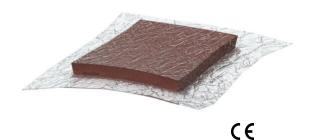
Versione sotto vuoto del Mattoncino antincendio FBA-B200-14 per l'installazione negli spazi ridotti, combinabile con la serie PYROPLUG® Block. Una volta terminato il montaggio, la pellicola viene tagliata e il blocco si espande nuovamente ritornando alle sue dimensioni originarie. La pellicola può restare nell'isolamento. Utilizzo in ambiente interno.
