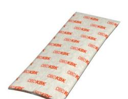
Cuscini antincendio per cavi in fibra di vetro a maglie fitte, a tenuta e meccanicamente resistenti con riempimento speciale. Senza fibre minerali, resistenti agli agenti atmosferici e insensibili all'acqua. Utilizzo in ambiente interno.
