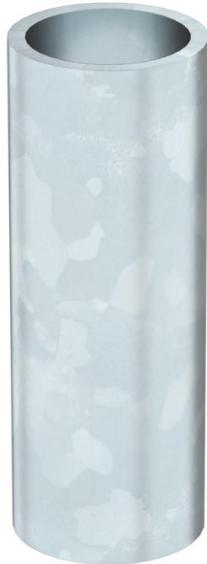
I manicotti di distanziamento per il montaggio di staffe sospese sotto soffitti isolati impediscono la pressione dell'isolamento con il serraggio delle viti di fissaggio. Senza sbavature, zincato internamente ed esternamente.
