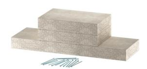
Blocco di attraversamento parete per canale antincendio PYROLINE® Con D El60, tipo PLCD D061220 composto da calcestruzzo in fibra di vetro leggero resistente all'acqua e al gelo per l'attraversamento di compartimentazioni. Costituito da 3 pannelli singoli (larghezza 100 mm, spessore 30 mm). Incluse viti a testa svasata.
