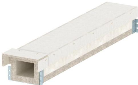
Canale antincendio in calcestruzzo leggero con fibra di vetro resistente all'acqua e al gelo della classe materiali A1 secondo la EN 13501-1 per la posa a prova d'incendio di cavi in vie di fuga e di soccorso. Classificazione EI30 - EI60 come canale di installazione secondo la EN 13501-2 sulla base di prove secondo la EN 1366-5. In caso di carico di incendio dall'interno (incendio di cavi), il canale ne impedisce la propagazione da una compartimentazione all'altra.
