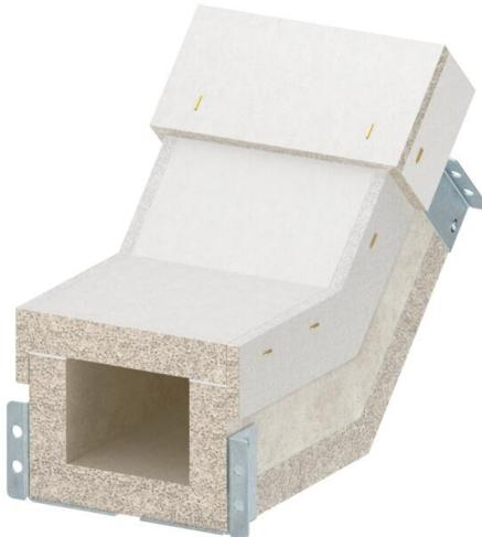
Curva verticale in salita per canale antincendio PYROLINE® Con S EI60, tipo PLCS D060810 in calcestruzzo leggero con fibra di vetro resistente all'acqua e al gelo per realizzare variazioni di direzione verticali (45°) nello sviluppo del canale. I materiali di collegamento consentono un rapido montaggio, i coperchi consentono una rapida ispezione e successiva implementazione.
