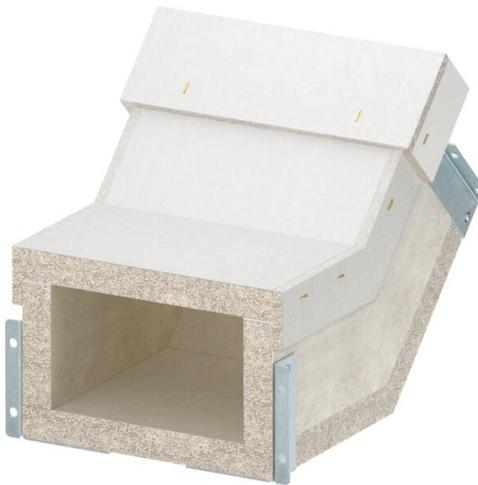
Curva verticale in salita per canale antincendio PYROLINE® Con S EI60, tipo PLCS D061220 in calcestruzzo leggero con fibra di vetro resistente all'acqua e al gelo per realizzare variazioni di direzione verticali (45°) nello sviluppo del canale. I materiali di collegamento consentono un rapido montaggio, i coperchi consentono una rapida ispezione e successiva implementazione.
