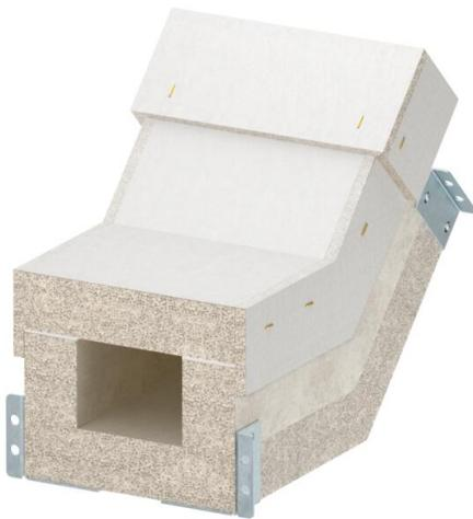
Curva verticale in salita per canale antincendio PYROLINE® Con S EI90, tipo PLCS D090810 in calcestruzzo leggero con fibra di vetro resistente all'acqua e al gelo per realizzare variazioni di direzione verticali (45°) nello sviluppo del canale. I materiali di collegamento consentono un rapido montaggio, i coperchi consentono una rapida ispezione e successiva implementazione.
