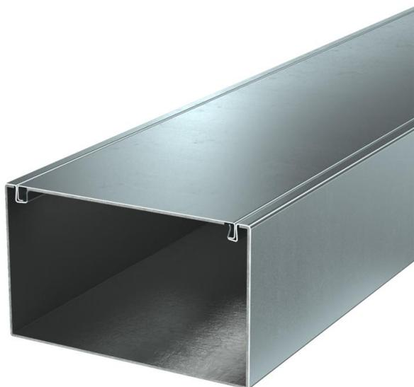
Canale in metallo con tessuto antincendio intumescente per la posa ignifuga dei cavi. Classificato come canale di installazione EI30, EI60 e EI90 a norma EN 13501-2, verificato secondo la norma EN 1366-5. Il canale impedisce la propagazione dell'incendio per l'intervallo di tempo classificato e protegge dalle conseguenze dell'incendio dei cavi.
