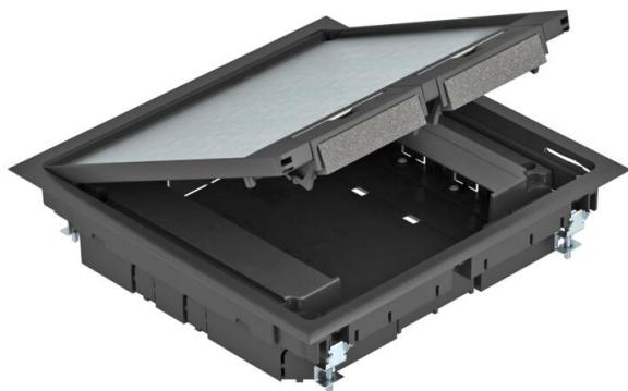
Torretta a scomparsa con maniglie ed uscite cavi orientabile con guarnizione in materiale espanso. Il coperchio incernierato è dotato di una piastra di rinforzo strutturale in lamiera d'acciaio con spessore di 4 mm e permette l'installazione di un rivestimento pavimento di 5 mm (regolabile anche a 10 mm).
